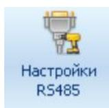
Кнопка «Настройки RS485» запускает утилиту изменения настроек любого из RS485 каналов и величины таймаута разрыва пакета в миллисекундах (с некоторыми адаптерами помогает организовать устойчивый обмен с устройством). Номер канала, для которого проводятся изменения, значение скорости обмена и связного адреса задаются в соответствующих строках. Для выполнения операции, будет запрошен пароль устройства.
