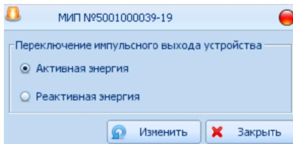
Рис. 5. Окно установки режима работы импульсного выхода.
