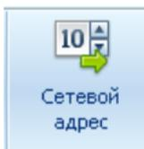
Кнопки «Сетевой адрес» служит для запуска утилиты изменения связного сетевого адреса устройства на шине RS485 в текущем канале. Выбранный адрес будет записан при нажатии кнопки «Изменить».
