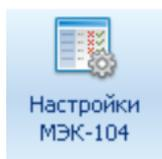
Утилита, позволяющая менять базовые адреса и таймауты для всех имеющихся каналов МЭК-104 в соответствии с Рис. 8. Важно контролировать, чтобы задаваемые в канале адреса не перекрывались и значения таймаутов соответствовало правилам протокола. Для выполнения операции записи, будет запрошен пароль устройства.
