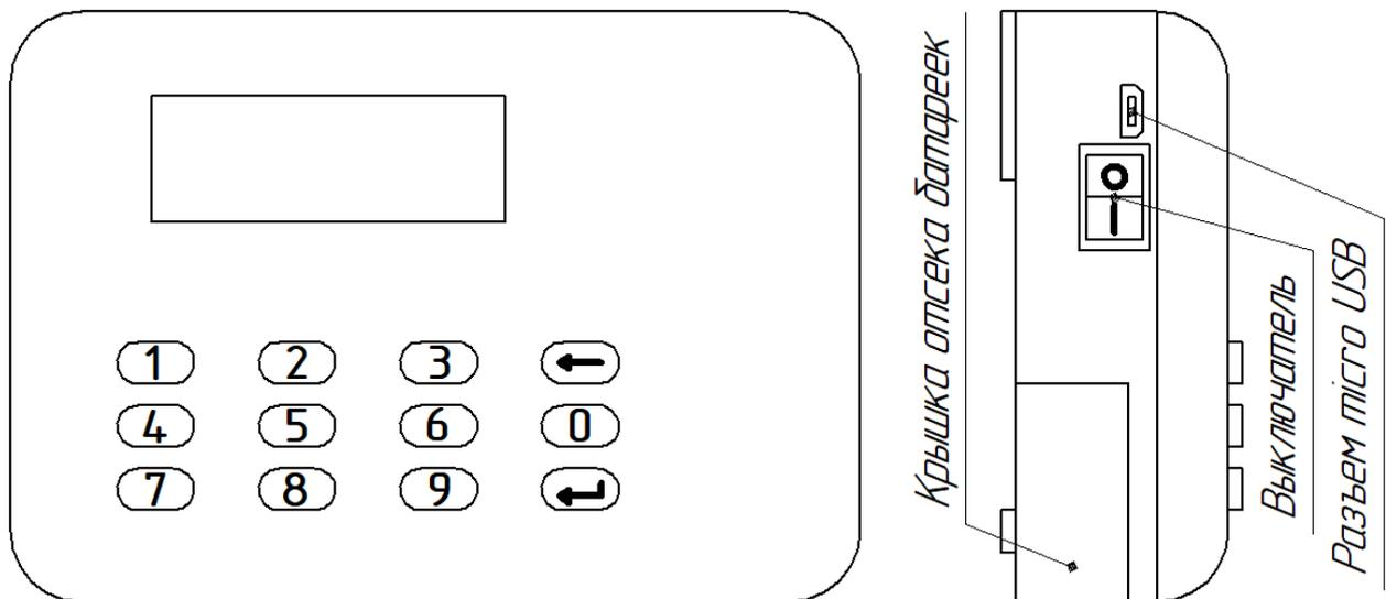
Рисунок А.2 - Внешний вид индикаторного устройства
