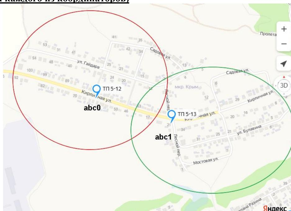
Для данного расположения ТП/РП на каждом координаторе сети устанавливаются уникальные ключи сети в диапазоне автоматически сканируемых ПУ (PAN\_ID в диапазоне **abc0..abc3**). После наладки координаторов ПУ списками подключенных к ней ПУ, счётчики, обнаруживая транслирующую MESH-сеть с совпадающим с их текущим PAN\_ID, делают попытки регистрации в сети.
